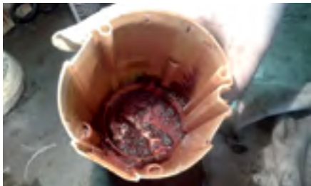
Pompa gasolio smontata di un'auto con 21.000 km di percorrenza e scarsa frequenza di utilizzo. Si possono chiaramente vedere i sedimenti e le alghe formatesi all'interno, le quali ostacolano il normale pompaggio del gasolio.
