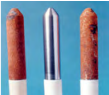
Sonda in acciaio immersa in carburante con acqua a 60°C per 24 ore.
