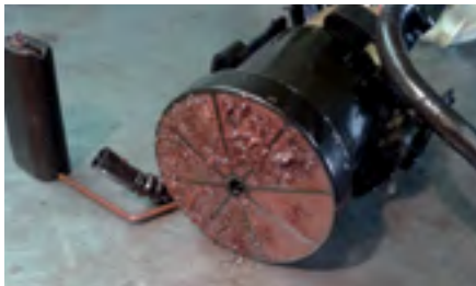
Pompa gasolio smontata di un'auto con 21.000 km di percorrenza e scarsa frequenza di utilizzo. Si possono chiaramente vedere i sedimenti e le alghe formatesi all'interno, le quali ostacolano il normale pompaggio del gasolio.
