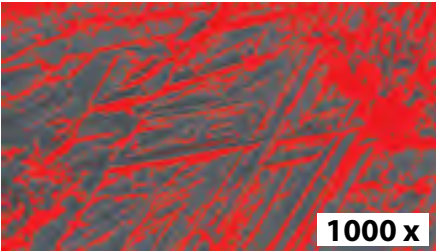
Il trattamento di rivestimento dei prodotti Sintoflon va a riempire le “valli” livellando le superfici, come evidenziato in rosso nel grafico.
